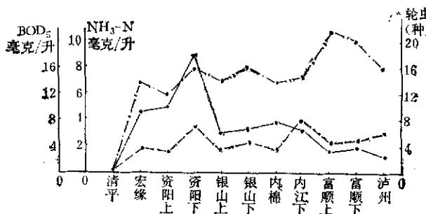
图 1 沱江干流 1984 年枯水期轮虫种类与  $\text{NH}_3\text{-N}$ ,  $\text{BOD}_5$  的关系
